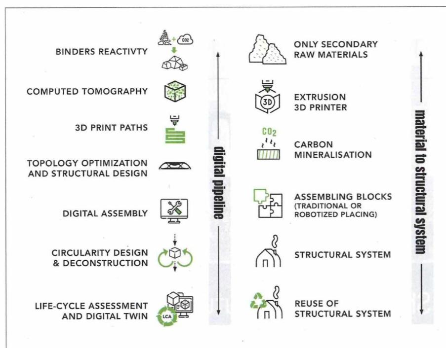
segmentée en une série de blocs de béton non armés, produits par impression 3D selon un procédé d'extrusion. Cette approche offre non seulement une grande liberté architecturale, mais permet également une construction qui priviliege la circularité : les blocs peuvent être démontés en fin de vie.
